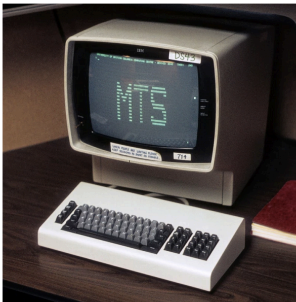
Abb. 5: Login zum Michigan Terminal System auf einem IBM 3277 Display-Terminal. Ein Terminal hat keine eigene Rechenkapazität. Es dient lediglich der Darstellung der, über die Telefonleitung übertragenen, Daten, die vom Mainframe berechnet werden und der Dateneingabe, die direkt an den Mainframe übertragen werden, zum Beispiel den IBM 360/67 (CC-BY 3.0 Michigan Terminal System Archive).
