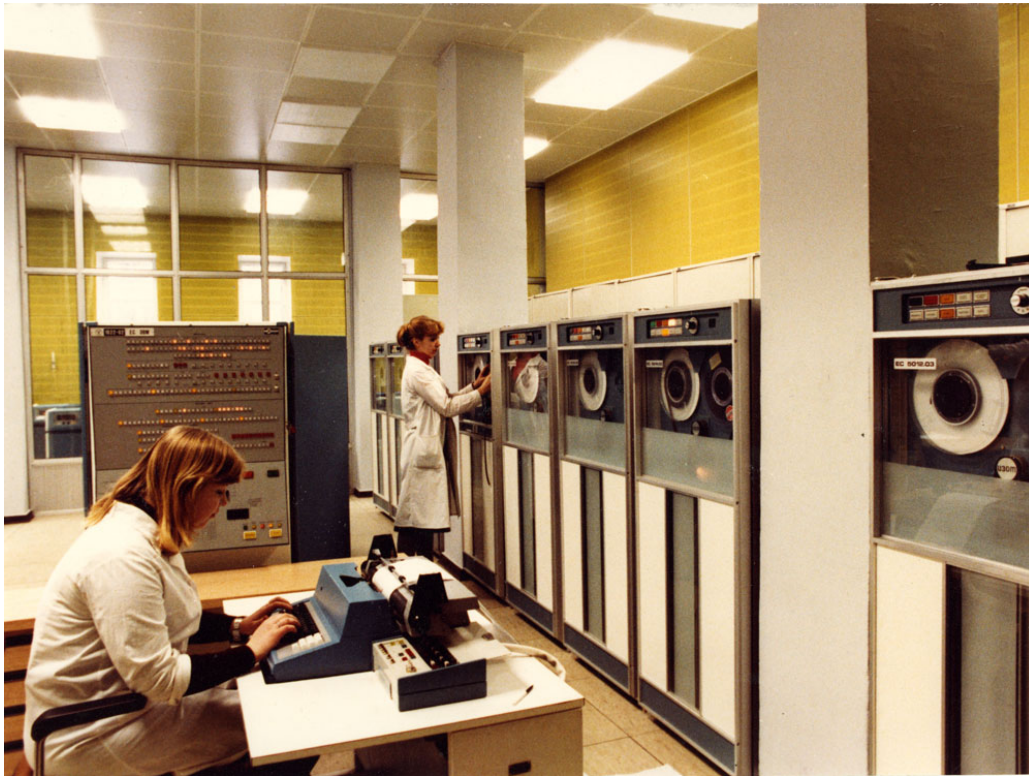
Abb. 76: ESER EC-1022 Großcomputer 1982 mit Tastaturterminal zur Eingabe, Magnetbandschränken zur Speicherung und Bedienkonsole im Bildhintergrund im Zentrum der staatlichen Archivierung der Raumfahrtokumentation Moskau. Dieser in der UdSSR und in Bulgarien produzierte Großrechner war Teil des ESER-Systems und stand auch für die Studierenden der TU Dresden zur Verfügung (Центр государственного хранения космической документации 1982).
