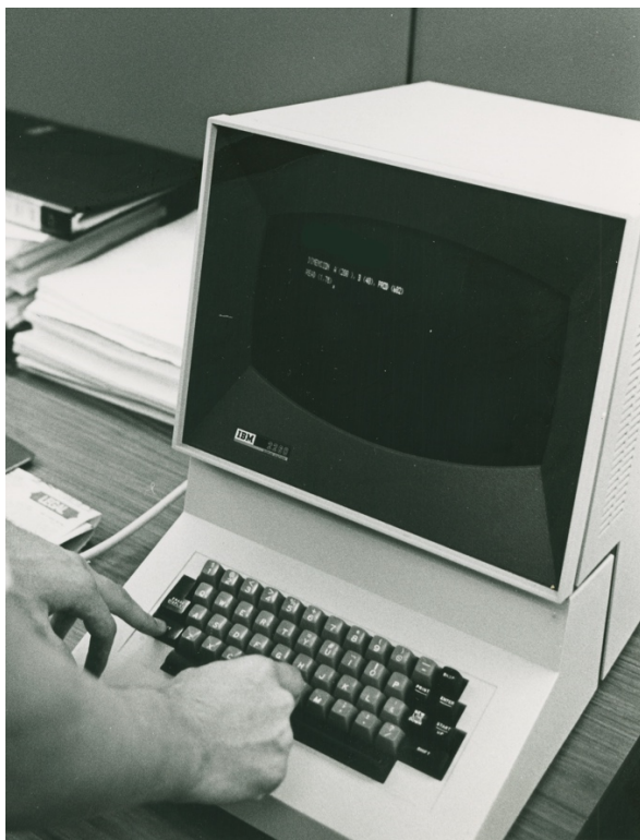
Abb. 43: Das IBM Terminal 2260, eine Bildschirm-Tastatureinheit ohne eigene Rechenkapazitäten, erlaubte den Fernzugriff auf die Ressourcen eines Zentralcomputers. Ryerson Computer Centre, ca. 1970er Jahre (Ryerson University – Library Archives, RG 63.72).
