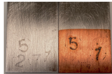
Abb. 3: Die elektrochemische Abscheidung von Kupfer an Eisen zur Sichtbarmachung der Lösungszahlen 5 und 1.
