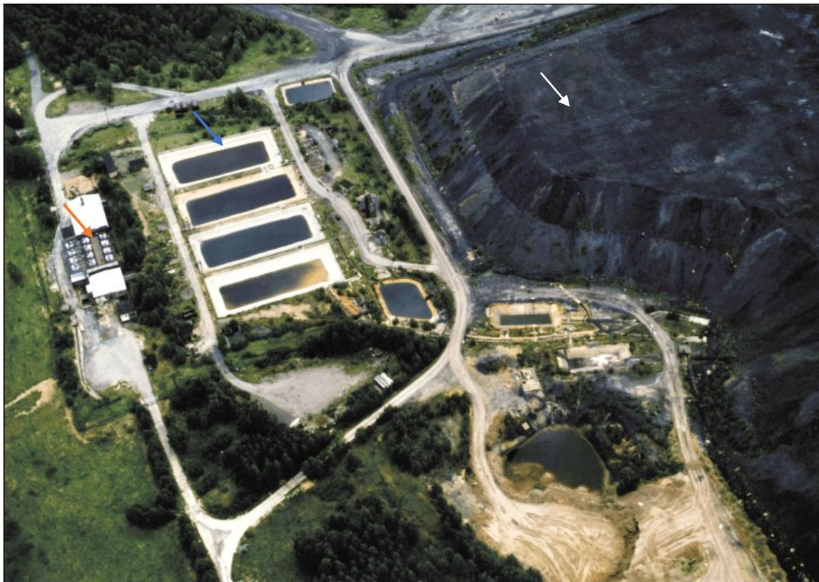
Abb. 2: Luftbild der Laugungsanlage Gessen. Rechts im Bild ist die Halde (weißer Pfeil) zu erkennen welche gelaugt wurde. In der Mitte-links (blauer Pfeil) sind die Auffangbecken zu sehen und links davon die Sorptionssäulen (orangefarbener Pfeil). Quelle: Wismut GmbH
