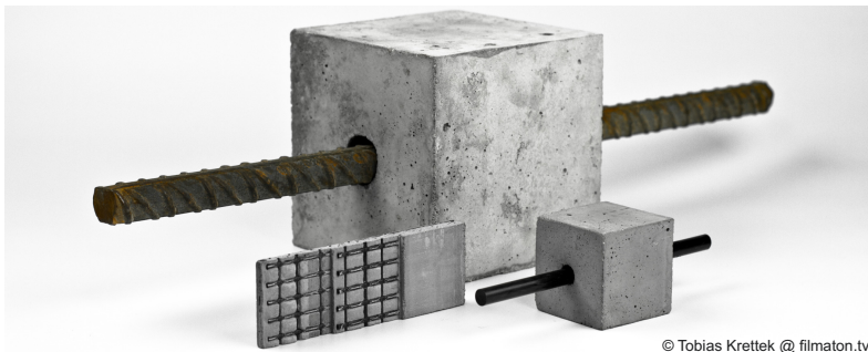
Abbildung 2.4: verschiedene Bewehrungsarten und die realisierbaren Mindestwandstärken für Stahl-, Carbonstab- und Textilbeton des C^3 -Netzwerkes [Car18]
