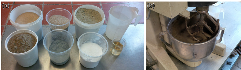
Abbildung 4.1: Betonbestandteile ohne grobe Gesteinszuschläge (a) und Mischvorgang (b)
