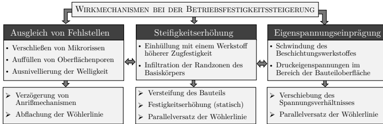
Abbildung 6.1: Wirkmechanismen bei der Betriebsfestigkeitssteigerung durch Oberflächenbeschichtung
