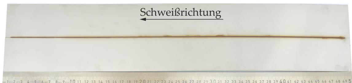
Abbildung 5.58: Draufsicht einer  $500 \text{ mm}$  langen Probe
