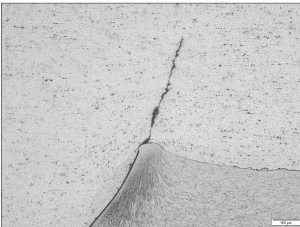
Abbildung 9-7: Anriss bei Frequenzabfall  $\Delta f = 0,1$  Hz und Oberkraft  $F_O = 0,9$  kN
