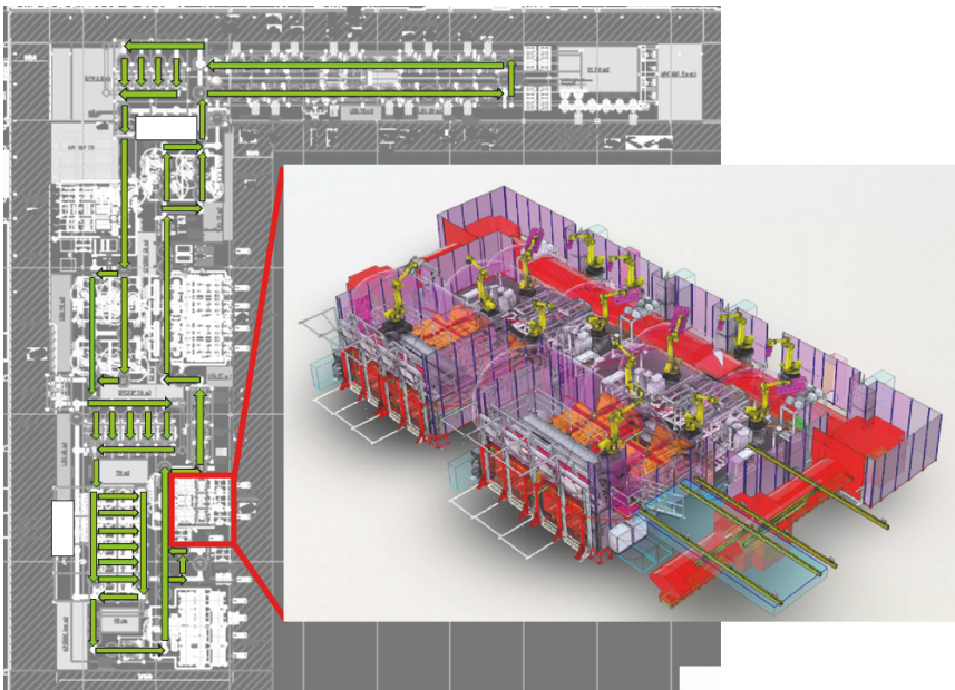
Abbildung 6: Überblickslayout der Batteriezellenmontage mit Startanlage in 3D
