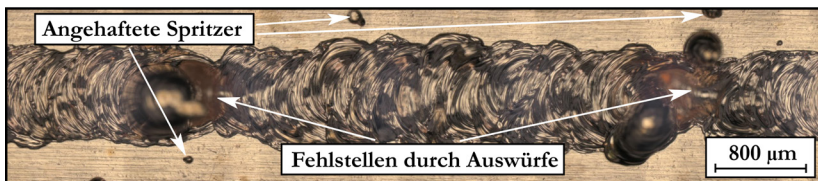
Abbildung 2-5: Nahtberraupe einer Schweißnaht in Cu-ETP, deren Entstehung mit der Bildung von Spritzern und Materialauswürfen einhergeht.
