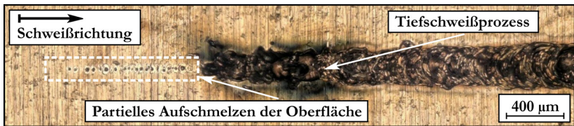
Abbildung 2-3: Nahtberraupe einer Schweißnaht in Cu-ETP. Prozessparameter: \lambda = 1030 \text{ nm} ; d_f = 85 \text{ }\mu\text{m} ; v = 0,5 \text{ m/s} ; P = 1000 \text{ W} .
