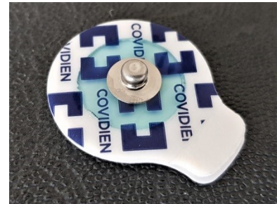
Abbildung 10 - Solid Gel-Elektrode zur EMG-Ableitung von Erdung, Referenz, M. orbicularis oculi und M. orbicularis oris
