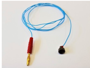
Abbildung 9 - speziell angefertigte Napfelektroden des Universitätsklinikums Jena zur EMG-Ableitung der Ohrmuskulatur
