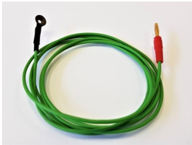
Abbildung 8 - Napfelektroden zur EMG-Ableitung der Ohrmuskulatur (GVB-geliMED GmbH)
