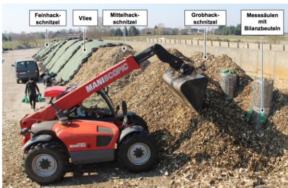
Abb. 7: Lagerversuch mit vliesabgedeckten Freihäufen (Jahr 2015)
