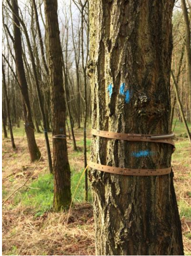
Abb. 12. Zuwachsmaßbänder an Robinien einer forstwirtschaftlich genutzten Fläche in Calau (Brandenburg) für die Analyse des Konkurrenzverhaltens. (Foto: Carl, 2017)
