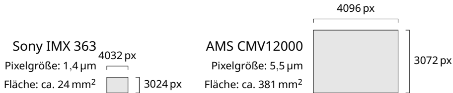
Abbildung 3.1: Zwei gängige Kamerasensoren. Beide Sensoren haben eine vergleichbare Anzahl an Pixeln (ca. 12 MPx). Der Sensorchip von Sony ist zum Beispiel in Smartphones verbaut, während der Sensor von AMS in Industriekameras Verwendung findet. Die Angaben stammen aus den jeweiligen Datenblättern der Hersteller.
