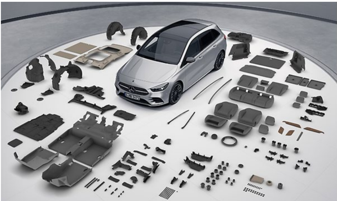
Abbildung 1.1: Einsatz recyclingfähiger Thermoplaste am Beispiel der Mercedes B-Klasse [Daimler Global Media]
