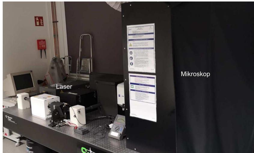
Abbildung 35: Foto des 2-Photonen-Mikroskops LSM 710 der Firma Zeiss. Im Hintergrund ist das Ultrakurzpuls-Ti:Saphire (Ti:Sa)-Lasersystem (Chameleon Ultra, Coherent Inc., USA) zu sehen (Laser). Des Weiteren ist der Strahlengang auf dem optischen Tisch bis zum Mikroskop abgebildet. Das Mikroskop selbst befindet sich im Vordergrund unter der schwarzen Abdeckung, welche die empfindlichen SEVs vor Raumlicht schützen soll.
