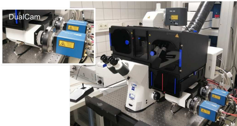
Abbildung 16: Photographie des Elyra 7 Systems der Firma Zeiss (rechts) mit DualCam Adapter und zwei sCMOS (PcoEdge; links).
