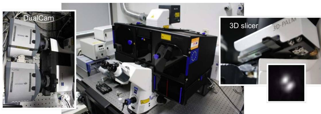
Abbildung 3: Photographie des Elyra P.1 Systems der Firma Zeiss (Mitte) mit DualCam Adapter und zwei EMCCD iXon+ (Oxford Instruments - Andor; links) und 3D slicer mit Phasenplatte und zugehöriger 3D-Doppel-Helix-PSF (rechts).
