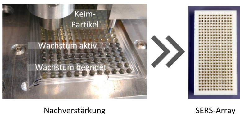
Abbildung 4-5: Nachverstärkung der Messstellen durch die Dosierung von Silbernitrat mit dem entwickelten Dosiersystem (links) und komplett benetztes SERS-Array (rechts)
