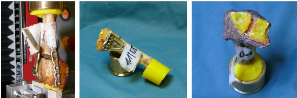
**Abb. 16:** operierte, instrumentierte und fixierte Präparate mit dorsalem Plattensystem (links), mit volarer Platte (Mitte), separate Einbettung der Fossa scaphoidea und lunata (rechts)
