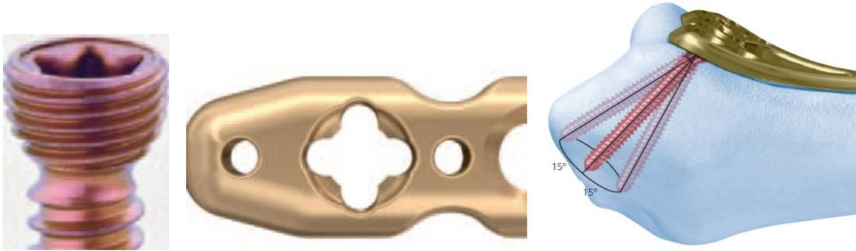
**Abb. 13:** Zu sehen sind ein konischer Schraubenkopf (links) mit Feingewinde, ein vierfach unterbrochenes Schraubengewindeloch (Mitte) und die daraus resultierende Möglichkeit der 15° Angulation (rechts).
