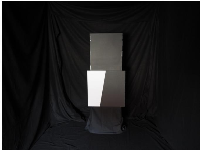
**Abbildung 8.4:** Das SE-Testbild ist drehbar gehalten und lässt sich auf der Plattform frei im Raum positionieren. Um Einflüsse von Störlicht zu minimieren, befindet es sich in einer lichtabsorbierenden Messzelle.
