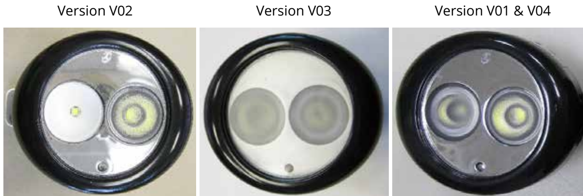
Abb. 3: Verschiedene Entwicklungsstadien der Testleuchte.
