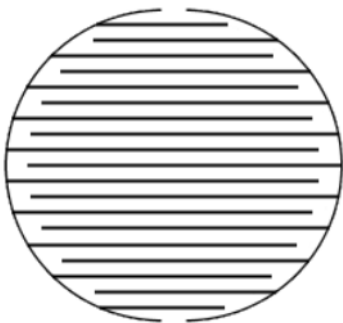
Abb. 5: Koplanare Anordnung des Elektrodenfelds auf dem Plasmachip
