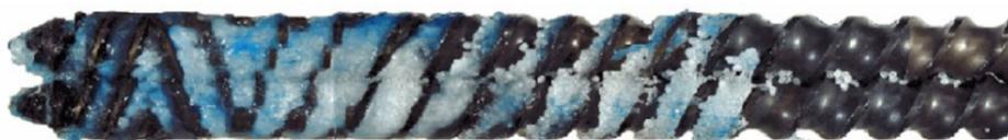
**Abbildung 2-7:** Gezogene Schnecke eines gleichläufigen Doppelschneckenextruder mit teilweise aufgeschmolzenen Granulaten [Bas00]
