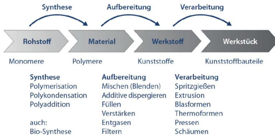
**Abbildung 1-1:** Prozesskette bei der Herstellung und Verarbeitung von Kunststoffen [Bon14]
