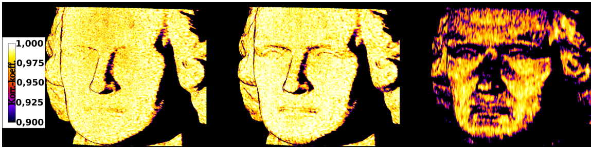
Abbildung 43: Räumliche Verteilung des normierten, zeitlichen Korrelationskoeffizienten aus Sicht der Führungskamera für vertikale Sinus-Filterung mit den Filtergrößen 2 (links), 5 (mittig), und 21 (rechts).
