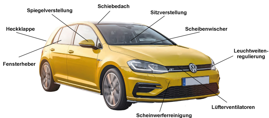
Abbildung 2.14: Auswahl von Elektromotoren im PKW (Darstellung nach [3], adaptiert)
