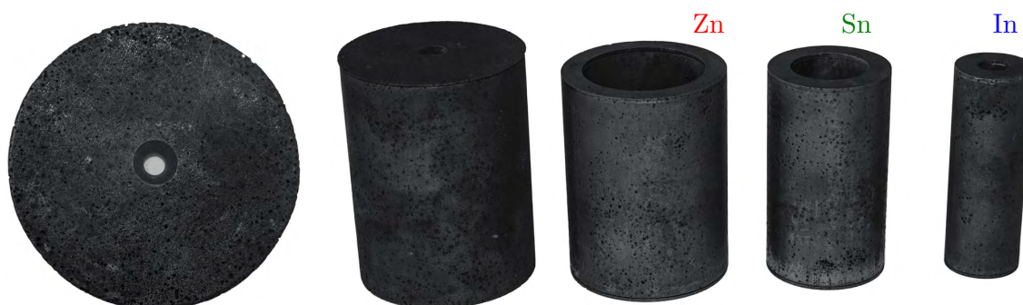
Abbildung 6.10: Foto der k-MFZ nach 3800 h Einsatz mit Deckel des äußeren Tiegels (Abbildung vergrößert). (Abbildungen freigestellt von Dipl.-Ing. Susanne Ecke).
