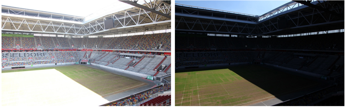
ABBILDUNG 2.1: Die gleiche Szene mit zwei verschiedenen Blendeneinstellungen aufgenommen. Links kommt es zu einer Überbelichtung und rechts zu einer Unterbelichtung.
