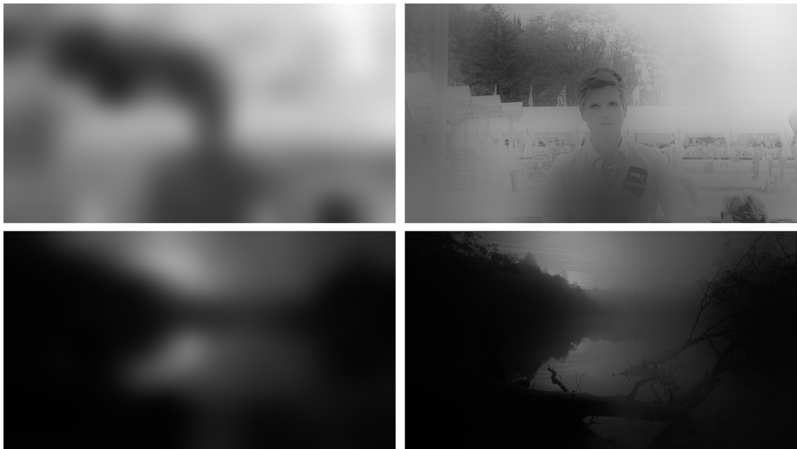
ABBILDUNG 6.7: Vergleich zwischen der bikubischen (links) und der bilateralen Filterung (rechts): Die bilaterale Filterung ist in der Lage die Kanten aus dem eingehenden Bild in die Maske zu transferieren.
