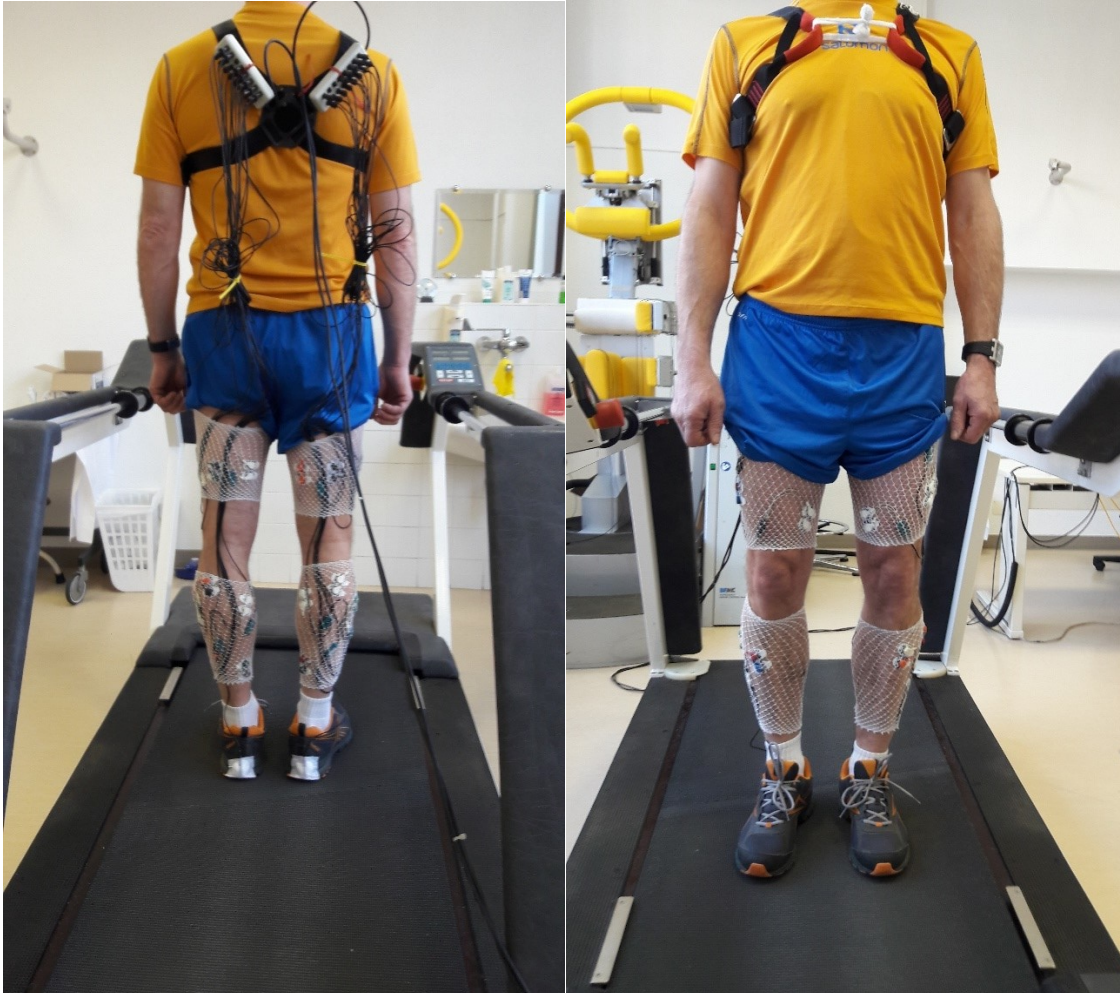
Abbildung 6 Proband mit angelegten Verstärkern, Fixierung mit Kabelbindern, Netzverbänden und Tragegurt, Ansicht von dorsal (links) und ventral (rechts.)
