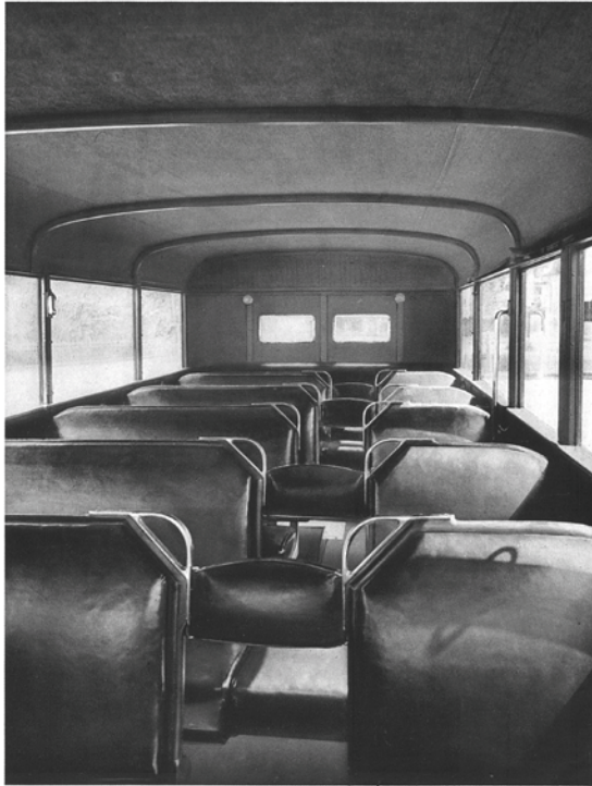
INNERES EINES GESCHLOSSENEN AUTOBUS / SAURER A.G., MASCHINENFABRIK UND GIESSEREI, ARBON Stuhlreihe, einfache Ausstattung - Jede Person entspricht nur dem Grade der Abgabe; Eingang entsteht durch die klare Wirkung der ohne Zierst verarbeiteten Materialien: Leder, Holz, Metall; Konform den Begriffen der Präzision, Geschwindigkeit, wandlungsfähiger Einwirkung mit der Funktion
