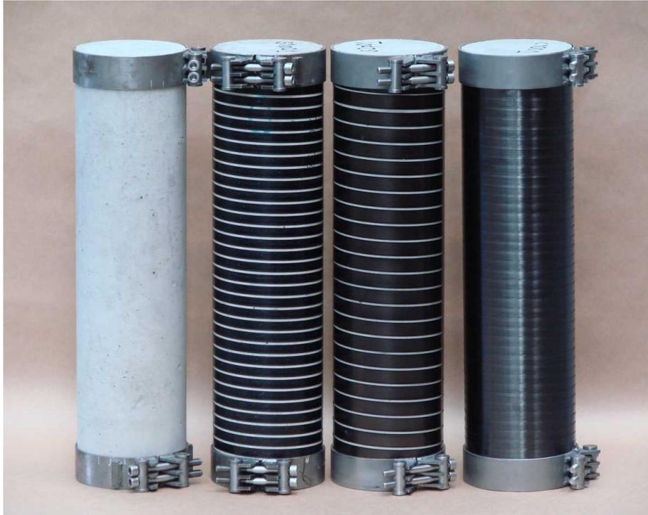
Bild 3.9: Umschnürte Zylinder: (v. l. n r.) Referenz, s2, s3, c
