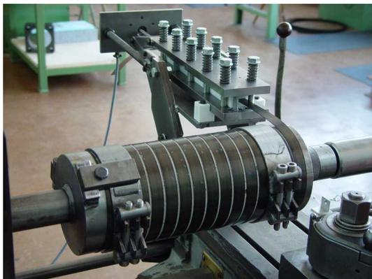
Bild 3.7: Drehbank nach dem Aufziehen, Verankerungsschellen gesetzt
