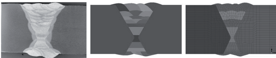
Abbildung 5: Gurtstoß; Makroschliff (li.), abgeleiteter Nahtaufbau (mi.), vereinfachtes Modell für die Berechnung (re.)
