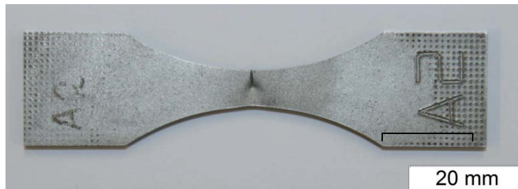
Abbildung 4: Kleinprobe mit Schwinganriss
