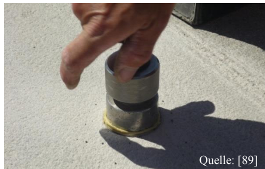
Abbildung 64: Anbringen des Gegenstempels
