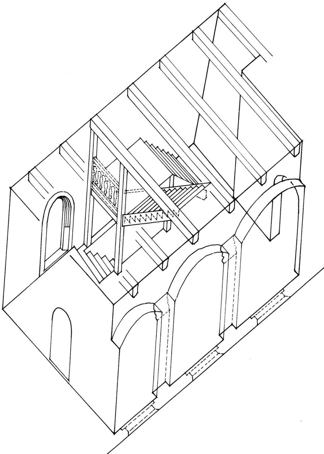
Abb. 255: Webergasse 1: Isometrie der Treppendiele im 1.OG, zeichn. Rekonstruktion
