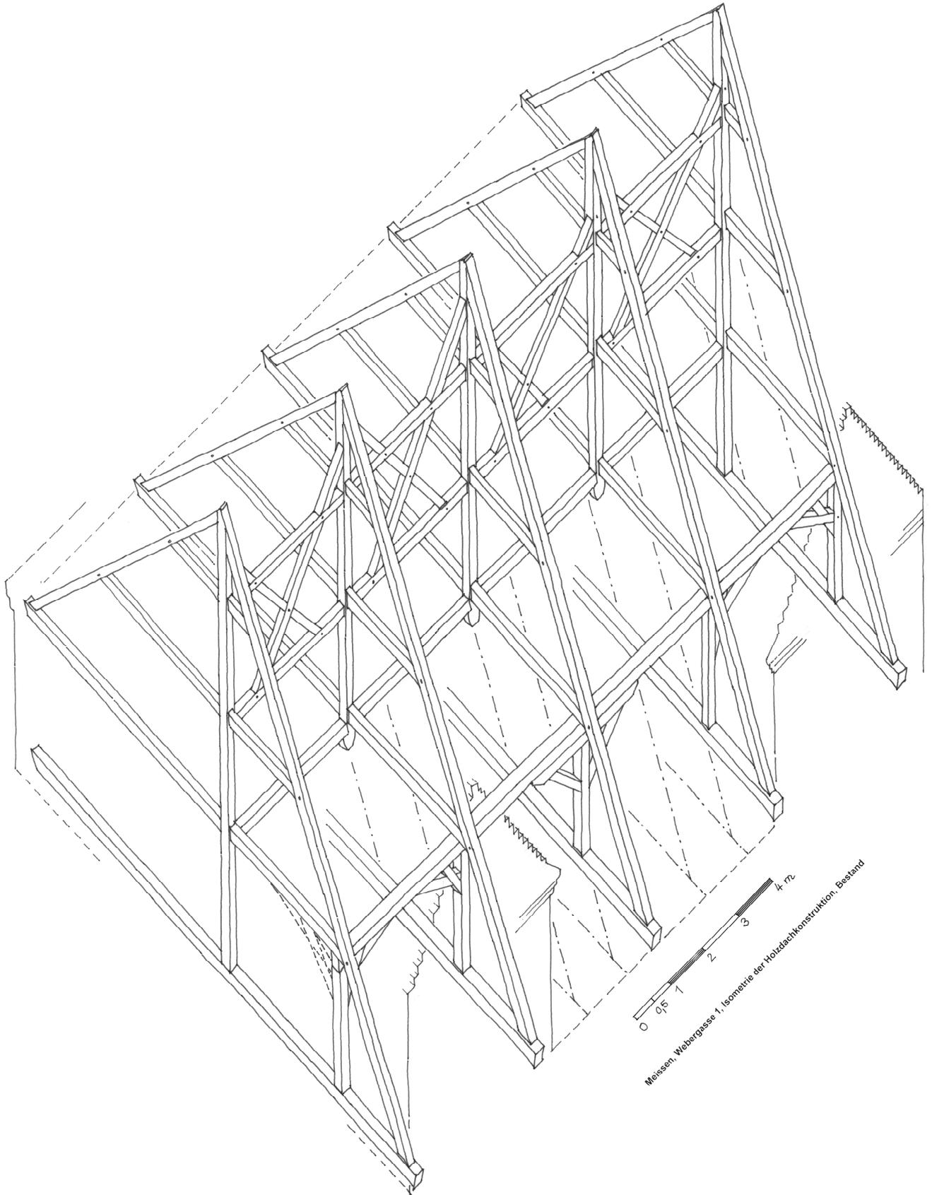
Abb. 253: Webergasse 1, Isometrie der Holzdachkonstruktion
