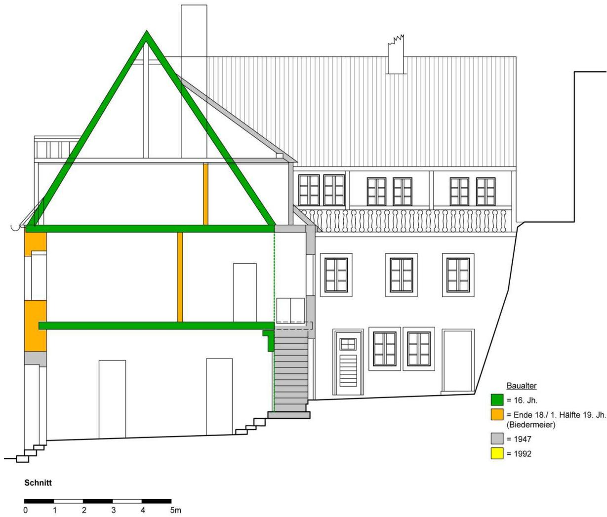
Abb. 77: Hohlweg 4: Baualtersplan Schnitt
