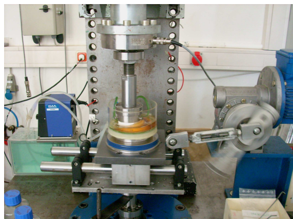
Abb. 36: Versuchsstand für Verschleißtests der neuen Kugel-auf-Platte-Geometrie am IMA in Dresden
