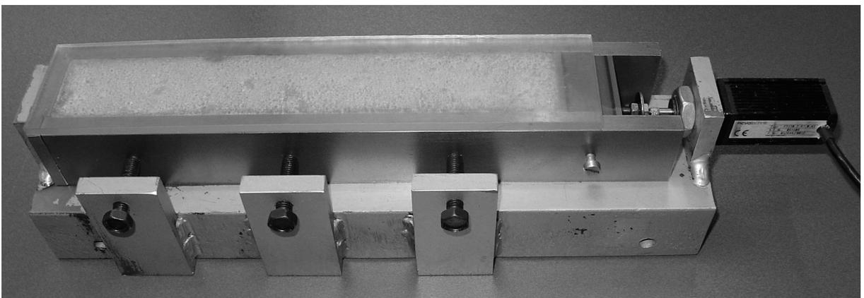
**Abb. 4-7:** *Schwindrinne mit seitlicher Behinderung und Abdeckung*
