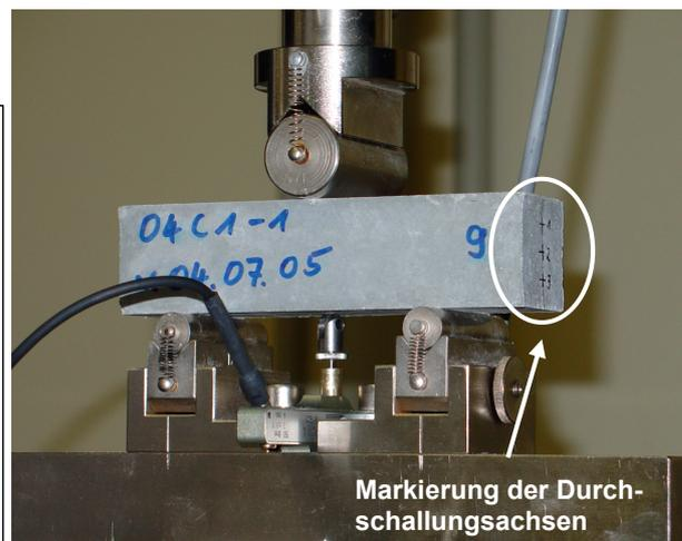
**Abb. 5-13:** Kraft-Durchbiegungskurven der Biegezugversuche **Abb. 5-14:** Versuchsaufbau Biegezugprüfung
