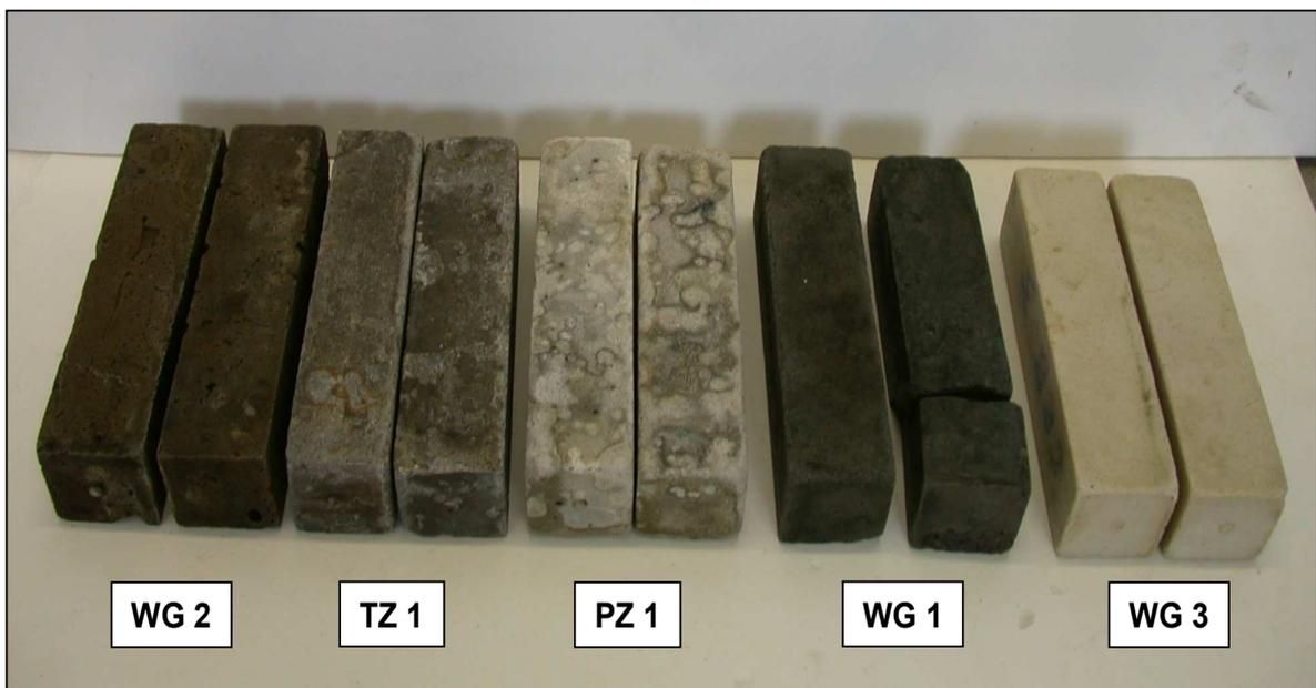
Abbildung 34: Normprismen der Auslagerungsproben nach einer Lagerungsdauer von 28 Wochen in einem Verteilerbauwerk der Kläranlage Nohra (Thüringen)
