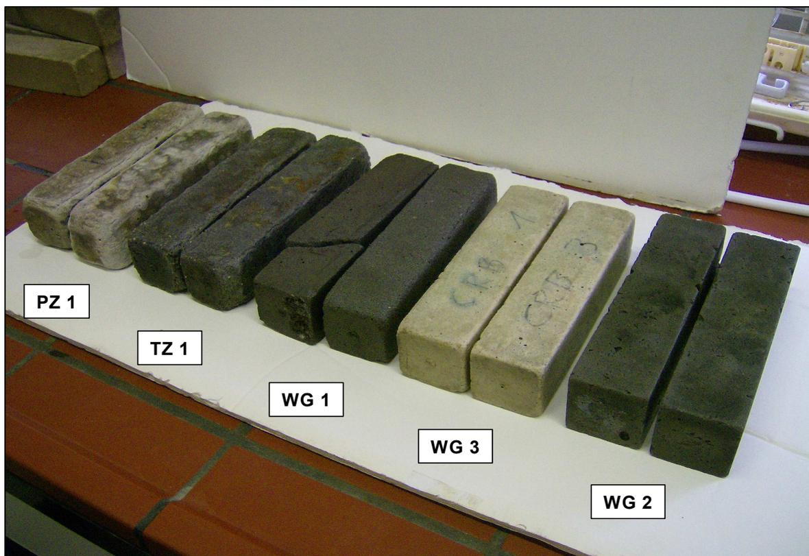
Abbildung 35: Normprismen der Auslagerungsproben nach einer Lagerungsdauer von 20 Monaten in einem Verteilerbauwerk der Kläranlage Nohra (Thüringen)
