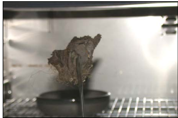
Bild 38: Morinolprobe nach Aufheizung auf 150 °C Proben-Kerntemperatur
