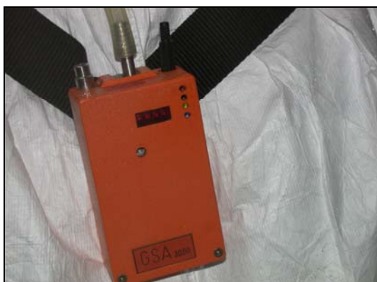
Bild 33: Probenahmepumpe PAS, Typ GSA 3000
