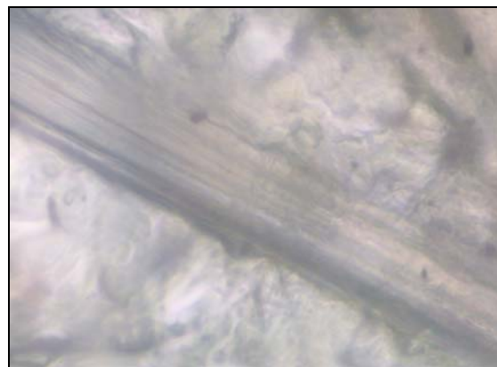
Bild 20: Asbestfasern eingebettet in der Kunststoffmatrix
