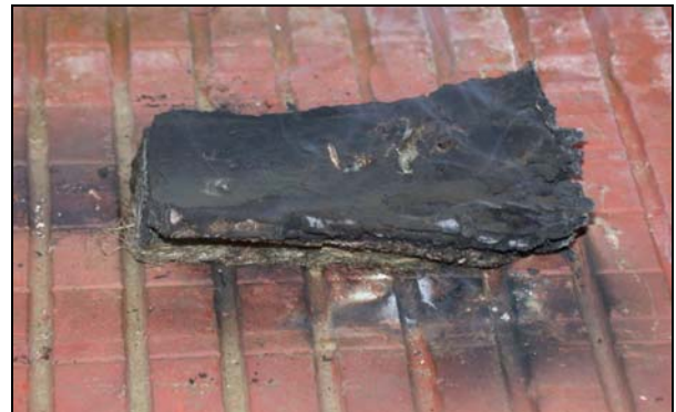
Bild 42: Verkohlter Morinolrückstand, Kernbereich unverbrannt
