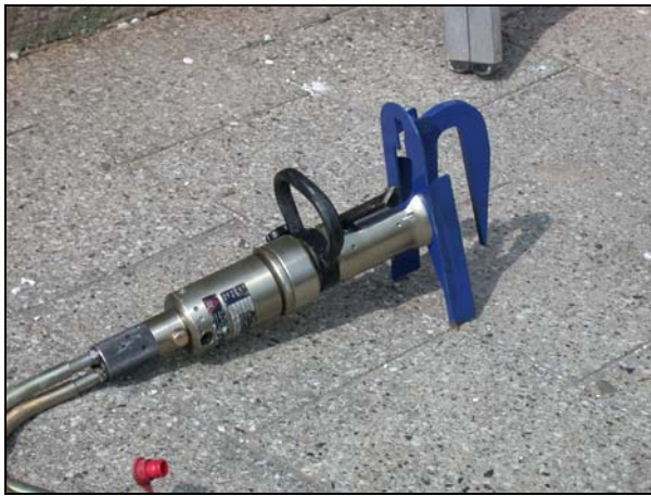
Bild 53: Hydraulikzylinder mit Werkzeugkopf
