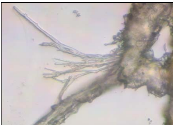
Bild 19: Randbereich mit herausragenden Asbestfasern
