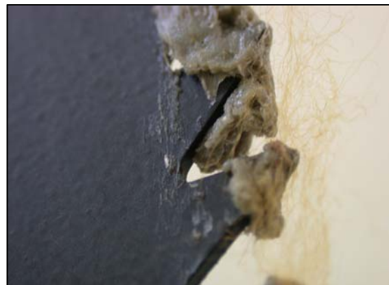
Bild 47: Sägezahn mit Fugendichtstoff
