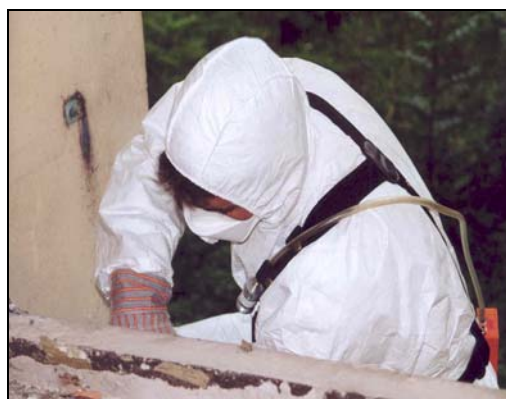
Bild 34: Messkopf mit Kernporenfilter im Atembereich
