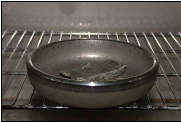
Bild 37: Morinolprobe bei einer Temperatur von 23 °C
