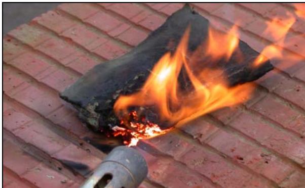
Bild 41: Verkohlung mit starker Rauch- u. Geruchsentwicklung
