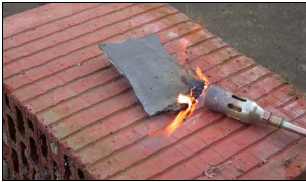
Bild 39: Beflammung der Morinolprobe
