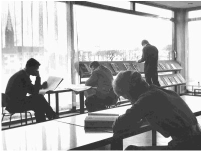
Abb. 56 Großformatige, stahlverstärkte Teakholzfenster der Stadtbücherei lassen das Tageslicht in die zum Lesen einladenden Bereiche
