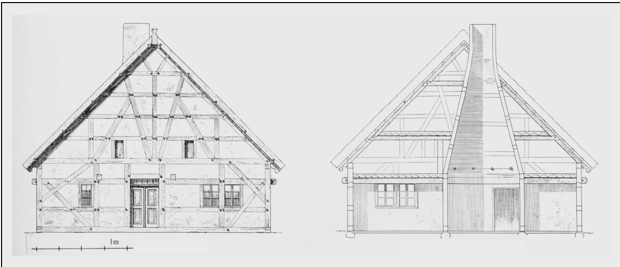
Abb. 15: Bäuerliches Wohnhaus in Alt-Blessin, Giebelansicht und Querschnitt, Aufmaß um 1900 (Baujahr nicht überliefert)
