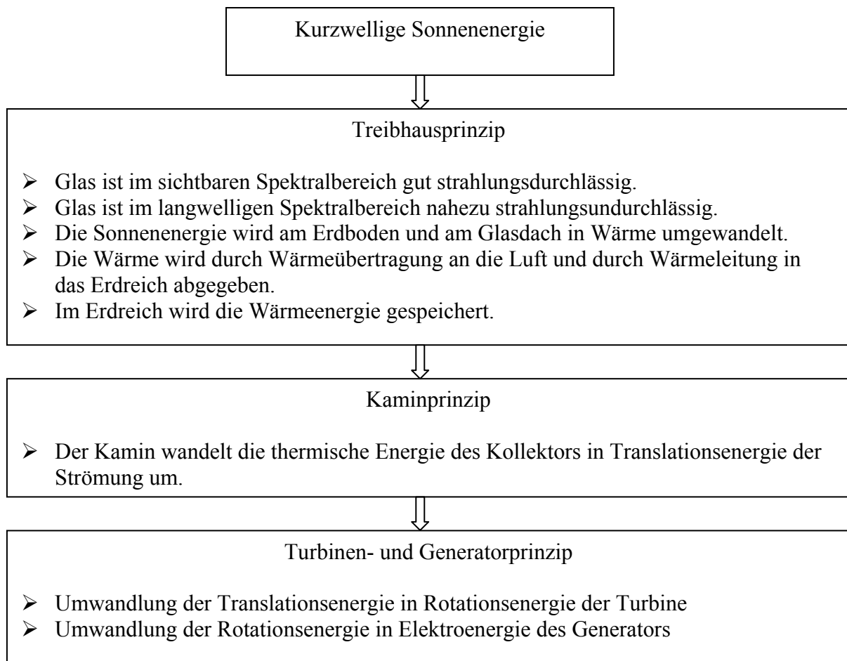
Abbildung 2.2 Prinzipielle Energiewandlungskette des Aufwindkraftwerkes.
