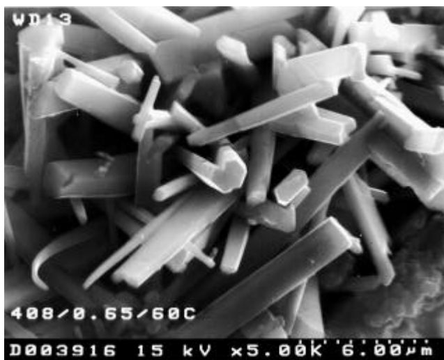
Abb. 150: Nadelförmige grobkristallin erscheinende Ettringitkristalle; REM-Aufnahme eines Feinkornbetons (mit Kohlenstoff-Bedampfung)
