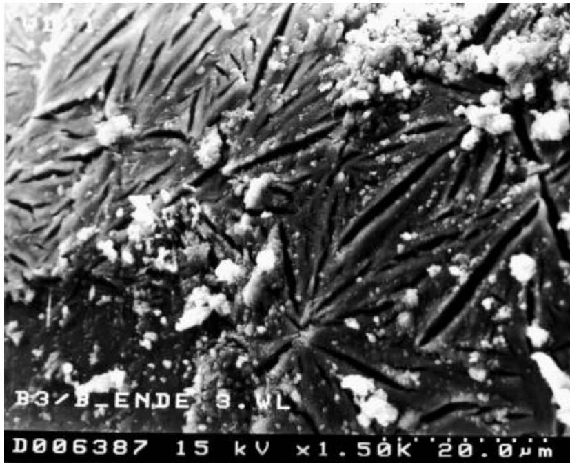
Abb. 5: Dichte Ettringitformationen auf der Oberfläche eines Quarzzuschlages in der Kontaktzone zur Matrix; REM-Aufnahme eines geschädigten Betons
