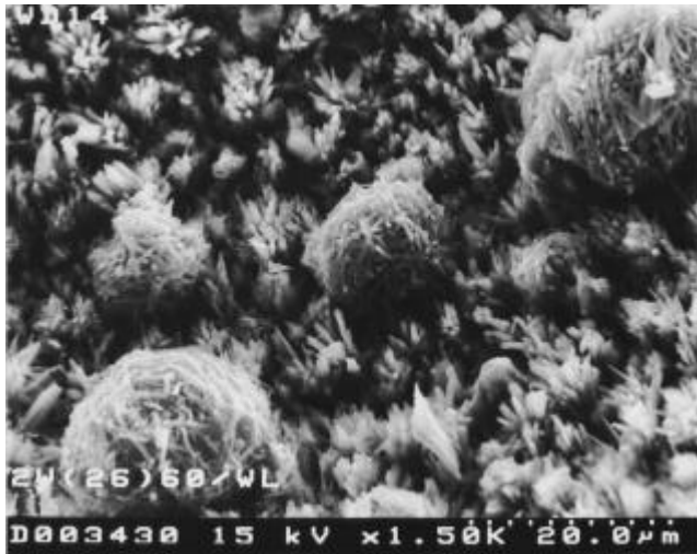
Abb. 143: Kugelförmige Ettringitformationen an einer Porenwand; REM-Aufnahme eines Straßenbetons
