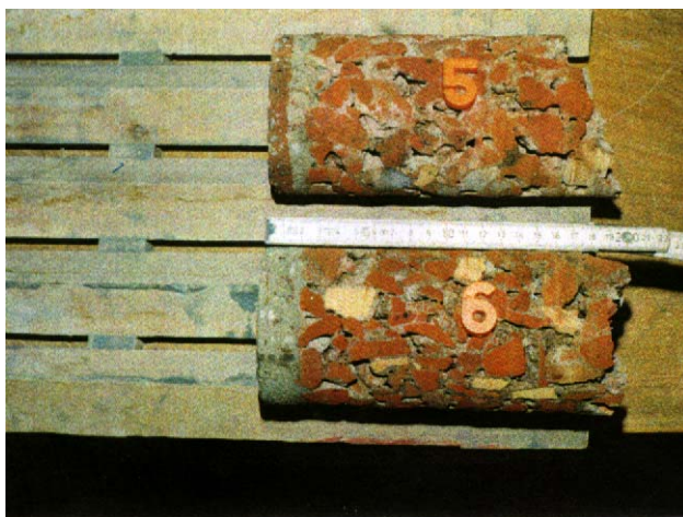
Bild 3.3 c) : Hauptzuschlagstoff Ziegelsplitt Bild 3.3 d) : Hauptzuschlagstoff Hochofenschlacke
