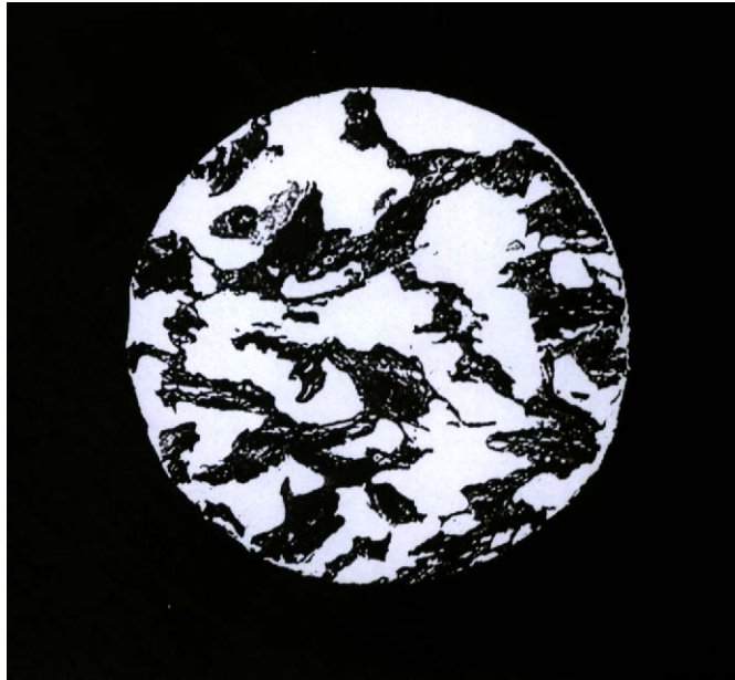
a) b) Bild 3.1 : a) mit Kontrastmittel gefüllte Schnittfläche eines Kernes b) eingescannte Schnittfläche nach dem Eliminieren der Feststoffporen
