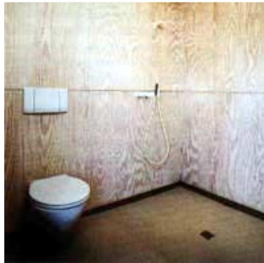
Abbildung 144 Sperrholzbekleidung im Bereich WC und Dusche
