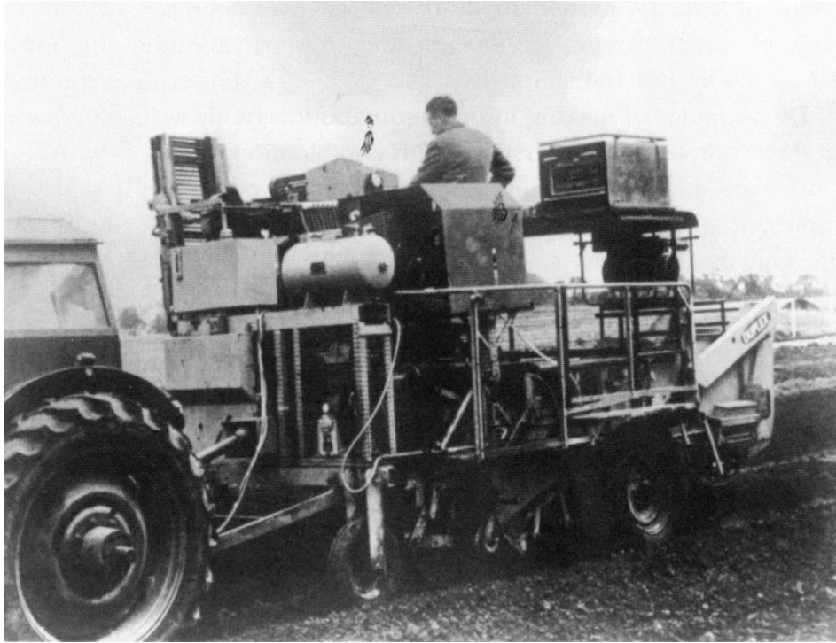
Praktische Versuche mit einer universalen Maschine: DEC PDP-8 als »potatoe-picker«
