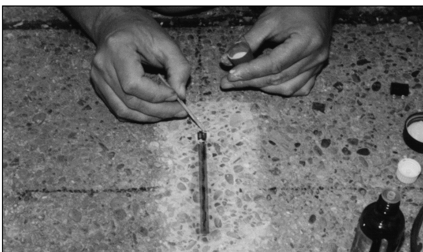
Abb. 56: Applikation von Dehnmeßstreifen zur Messung der Betonstauchung
