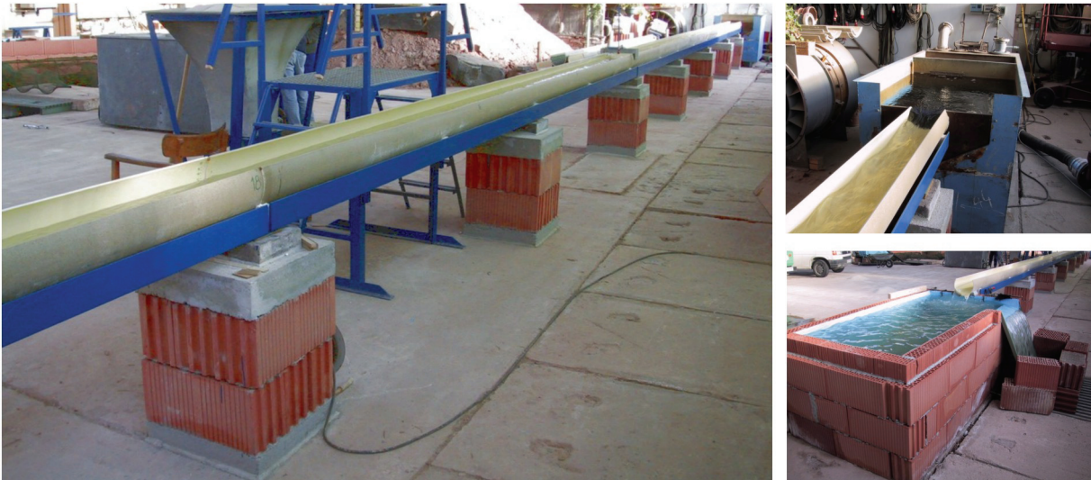
Abb. 6: Versuchsrinne aus GFK-Rohrschalen (links: Gesamtansicht; rechts oben: Zulauf; rechts unten: Ablauf) [8], [9]
