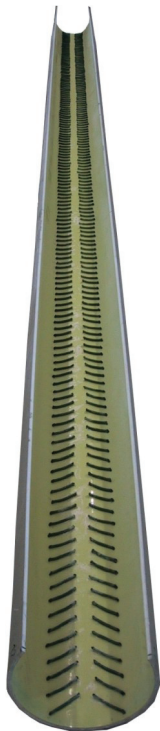
Abb. 6: Versuchsrinne aus GFK-Rohrschalen (links: Gesamtansicht; rechts oben: Zulauf; rechts unten: Ablauf) [8], [9]
