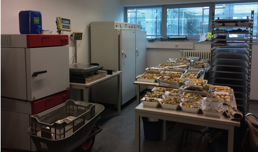
Abb. 2 Untersuchungslabor der Fachhochschule Erfurt, Trocknung und Wägung der geschredderten Holzproben (Foto: C. CARL).
