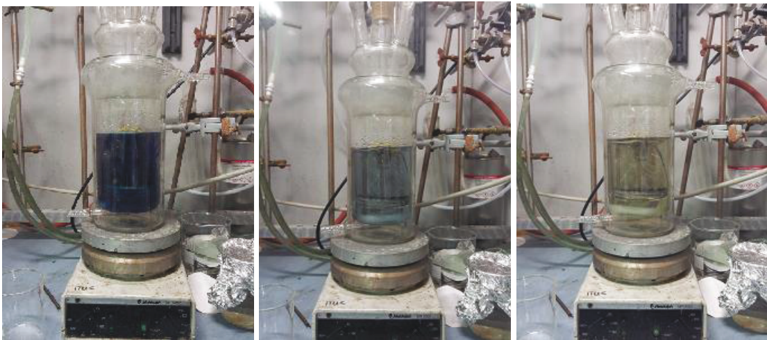
Anh. Abb. 4: Entfärbung der Methylenblaulösung bei pH7 durch 10\text{g m}^{-3} \text{O}_3 in 45\text{ l h}^{-1} (rechts: nach 5 min; Mitte: nach 10 min; links: nach 15 min)
