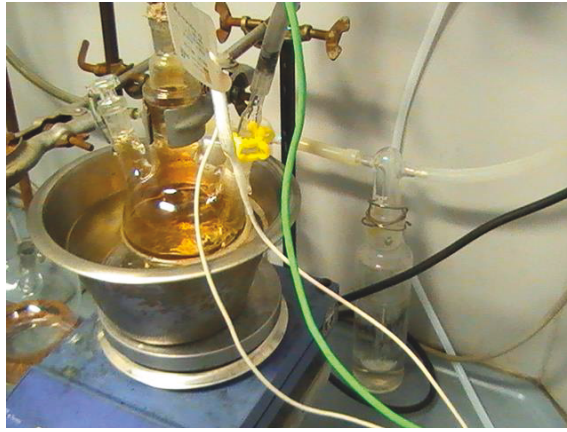
Anh. Abb. 3: Generierung von \text{NO}_2 (gelbes Gas) im Kolben aus \text{HNO}_3 und \text{H}_2\text{SO}_4 bei 80^\circ\text{C}
