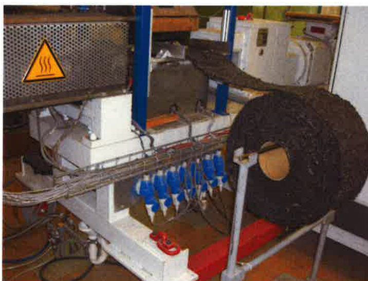
Abb. 10: Einzug von Vliesstreifen in den Mischextruder
