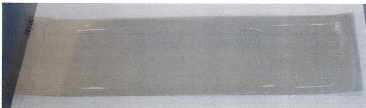
Abb. 16. ITO-Folie beschichtet mit PEDOT-PSS und Festelektrolyt mittels Rakeltechnik.
