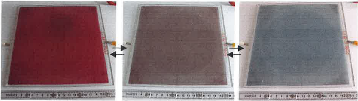
Abb.28. ECMG 5-18 IS, elektrochromer Effekt, demonstriert an einem EC-Modul mit P3HT-Polymer im neutralen Zustand (weinrot) und oxidierte grau/ila sowie blaue Form, EC-Fläche: ca. 400 cm 2 .
