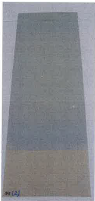
Abb.12. PEDOT-PSS beschichtet auf ITO-Folie mittels Rakeltechnik.
