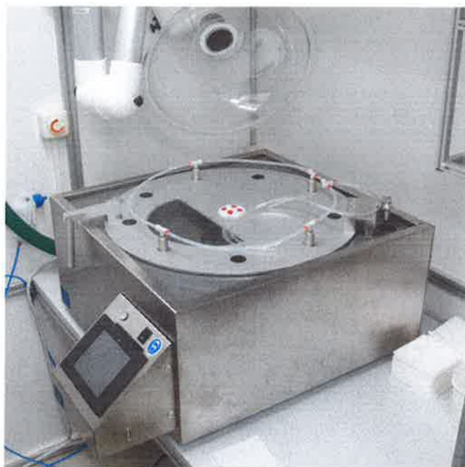
Abb.13. Der neu angeschaffte Spin-coater Cee 300X von Brewer Science für Proben bis zu 450 mm (Durchmesser).
