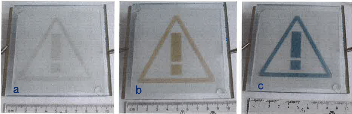
Abb. 38 a-c. EC-Modul mit farbig schaltbarem Warnzeichen-Piktogramm. Fläche ca. 100 cm 2 .
