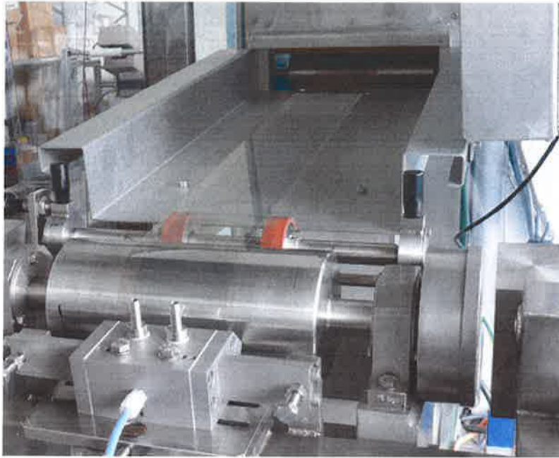
Abb. 40. Rolle-zu-Rolle Beschichtung einer PEDOT-PSS Probe.
