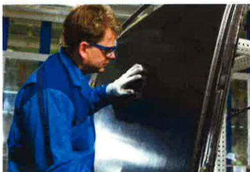
Abb. 19: CFK-Dach für den BMW i3 [18]
