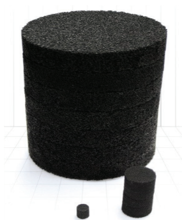
Abbildung 18: Beschichtete Schaumkörper mit 30 ppi für die drei verschiedenen Reaktorgrößen
