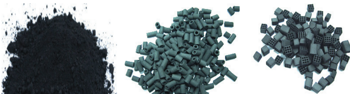
Abbildung 14: Katalysatorpulver 184; Katalysator G 130 aus Pulver 184, Hohlzylinder (30 % Porosität, \rho = 1,97 \text{ g/cm}^3 ); Katalysator G 129 aus Pulver 184, Miniwabe (30 % Porosität, \rho = 1,49 \text{ g/cm}^3 )
