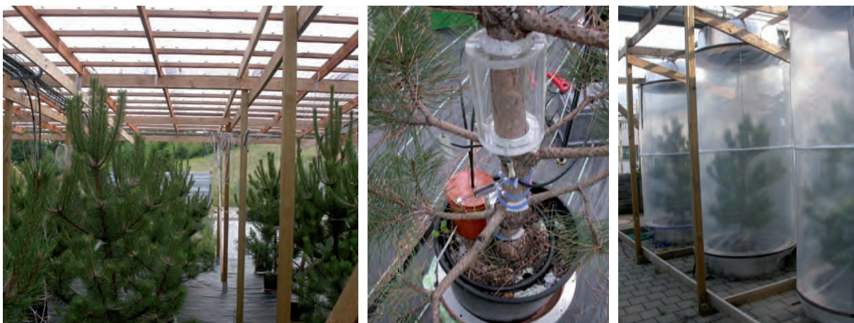
Trockenstressexperiment, bei dem die Mechanismen des Baumsterbens infolge von Trockenheit bestimmt werden. Alle physiologisch relevanten Funktionen und Prozesse der gestressten Bäume (insbesondere die Kohlenstoffverteilung und -flüsse) werden mittels Sensoren nachverfolgt.
