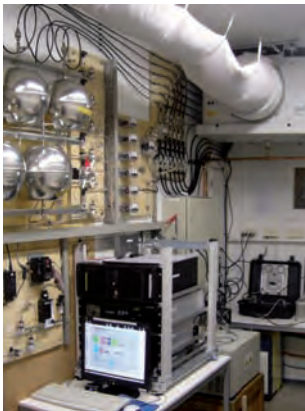
Am ZOTTO-Turm erlauben die sphärischen Puffervolumen (oben links) eine nahezu gleichzeitige Messung von Luft aus allen sechs Einlasshöhen mit einem einzigen Messinstrument.
