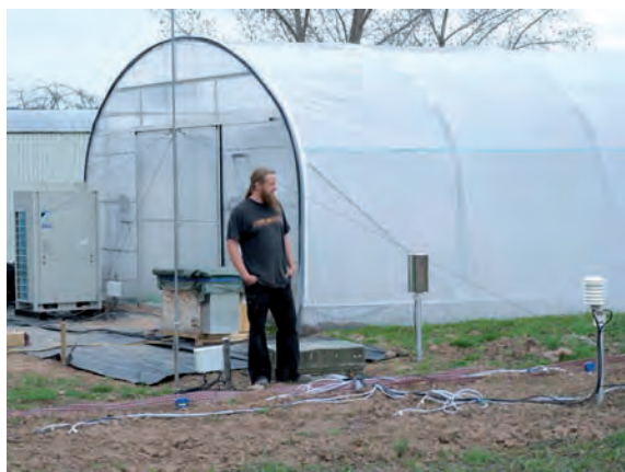
Wir untersuchen den Weg von neuem, pflanzenbürtigem Kohlenstoff im Boden, indem wir Pfefferminzpflanzen im Gewächshaus kontinuierlich über das \text{CO}_2 der Luft mit einer bestimmten Isotopenzusammensetzung markieren (Quasom-Freilandexperiment).
